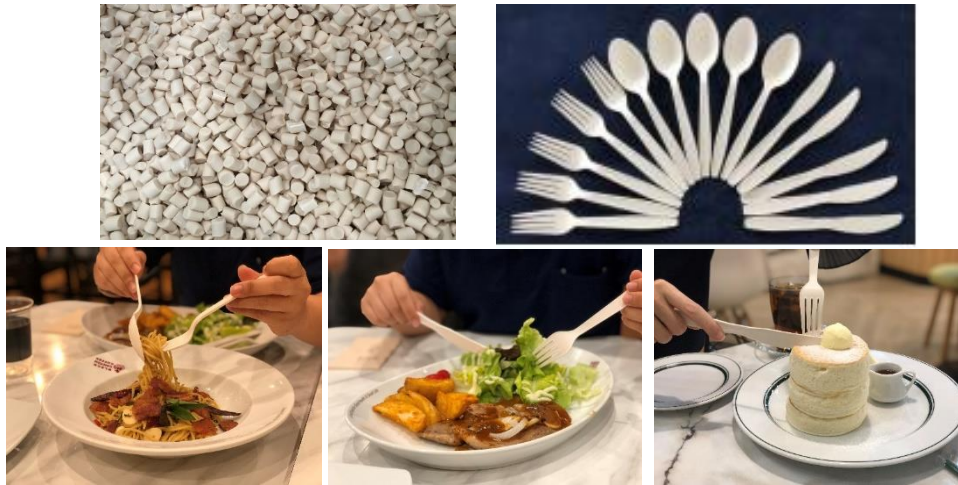
รูปแสดงเรซินเทอร์โมพลาสติกสตาร์ชและต้นแบบผลิตภัณฑ์ที่ย่อยสลายได้
