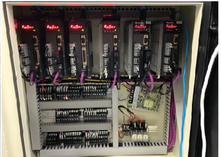
รูปที่ 1 Refurbished Robot และ Refurbished Motion Controller โดยใช้โปรแกรม CiRA Polishing เพื่องานขัดพื้นผิว
