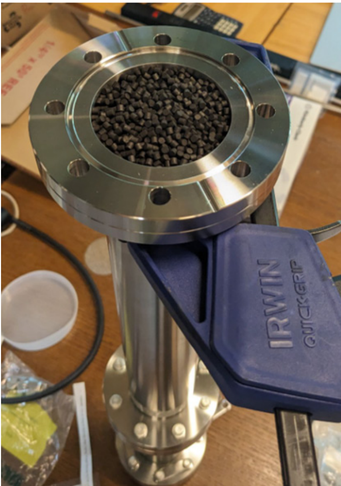
การประกอบท่อกรองด้วยการบรรจุวัสดุกรองเข้าไปในท่อสแตนเลส
