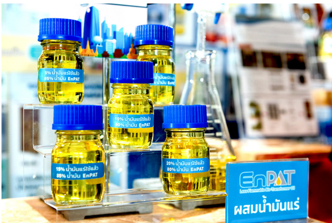
ขวดแสดงการผสมระหว่างน้ำมัน EnPAT กับน้ำมันแร่ที่ผ่านการใช้งานแล้วในสัดส่วนต่าง ๆ
