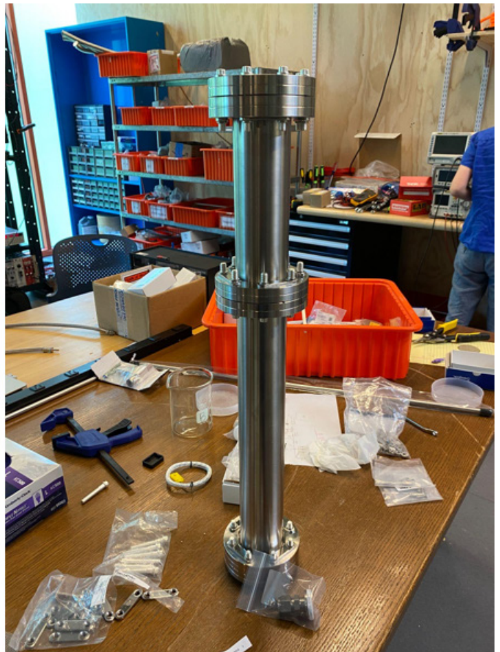
การประกอบท่อกรองด้วยการบรรจุวัสดุกรองเข้าไปในท่อสแตนเลส
