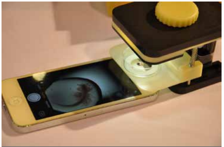
MuEye System เปรียบเสมือนกล้องจุลทรรศน์แบบพกพาที่ใช้ร่วมกับโทรศัพท์มือถือ-สมาร์ทโฟนได้เป็นอย่างดี
