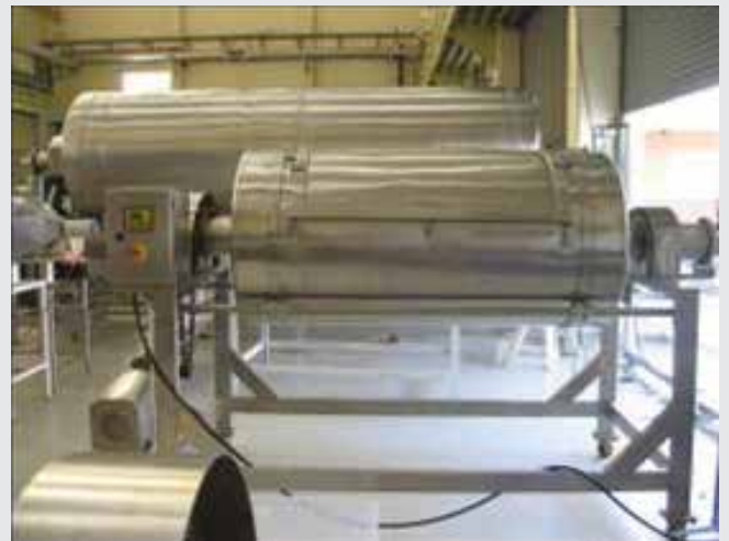
การผลิตอูมามิแบบกึ่งแห้งในถังหมักแบบหมุน
