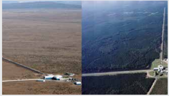
ภาพถ่ายทางอากาศแสดงอินเตอร์เฟอโรมิเตอร์ของไลโกที่แฮนฟอร์ดและลิฟวิงสตัน (ภาพ: LIGO)
