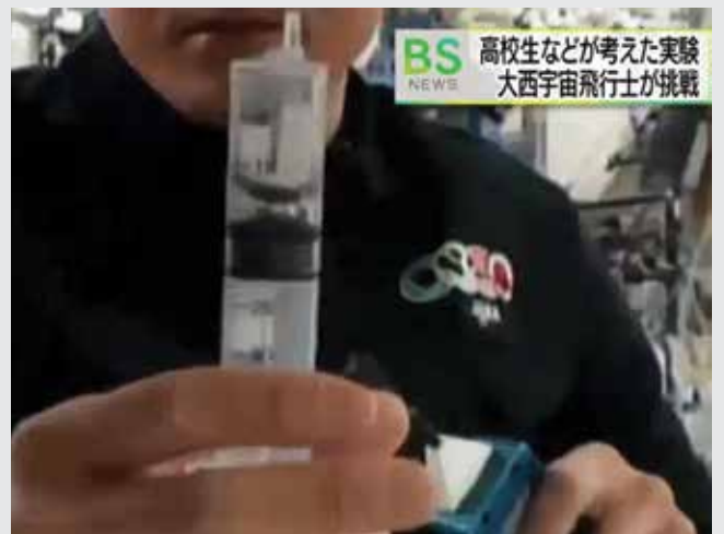
การทดลองที่แสดงให้เห็นผิวของน้ำมันเว้าลงอย่างมากในสภาวะไร้น้ำหนักบนสถานีอวกาศนานาชาติ
