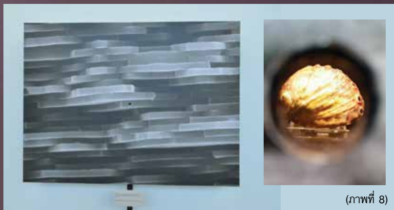
ภาพที่ 8 ภาพขยายของภาพที่ 7 เปลือกหอยเป่าอื้อ ประกอบด้วยแผ่นแคลเซียมคาร์บอเนตบางๆ มีขนาดระดับนาโนเมตร เรียงซ้อนทับกันหลายชั้น ทำให้เปลือกหอยเป่าอื้อแข็งแรงแตกยาก
