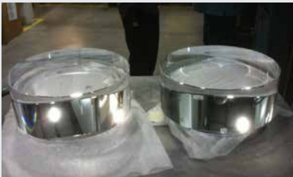
กระจกที่ไลโกใช้ ซึ่งทำจากซิลิกาบริสุทธิ์ แต่ละชิ้นหนัก 40 กิโลกรัม (ภาพ: Caltech/ MIT/ Ligo Lab)
