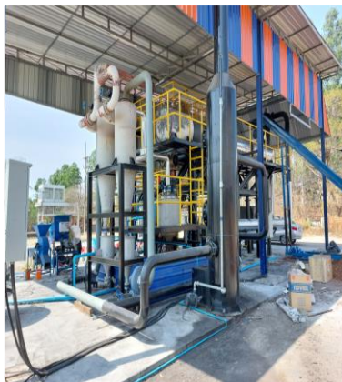
ต้นแบบกระบวนการผลิต Biocoal ระดับ Pilot plant ขนาดกำลังป้อนชีวมวล 1 ตัน/วัน
