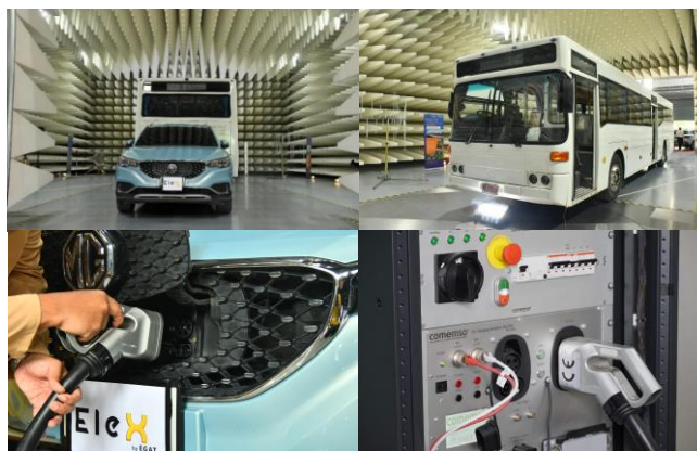
PTEC สวทช. ให้บริการทดสอบ EV charger ตามมาตรฐาน IEC 61851 และ มอก. 61851
