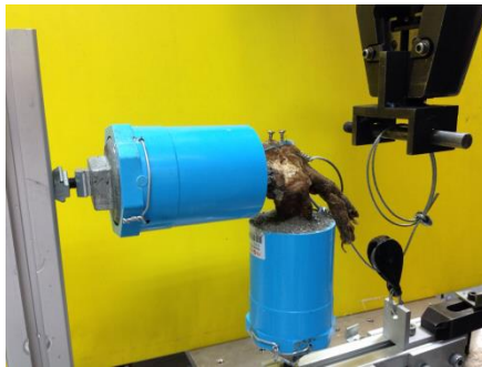
อุปกรณ์ช่วยจับยึดสำหรับทดสอบเส้นใยยึดข้อศอกบนเครื่องทดสอบแรงดึง
