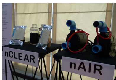
รูปที่ ๑ ระบบเอ็นค่า ประกอบด้วย เอ็น-เคลียร์ สารจับตะกอน (ซ้าย) และเอ็น-แอร์ เครื่องเติมอากาศ (ขวา)
