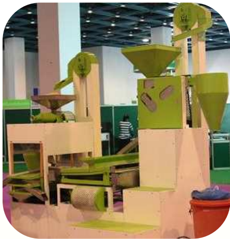
เครื่องสีข้าวขนาดเล็กสำหรับครัวเรือนและชุมชน (กำลังการสี 200 กิโลกรัมข้าวเปลือกต่อชั่วโมง)
