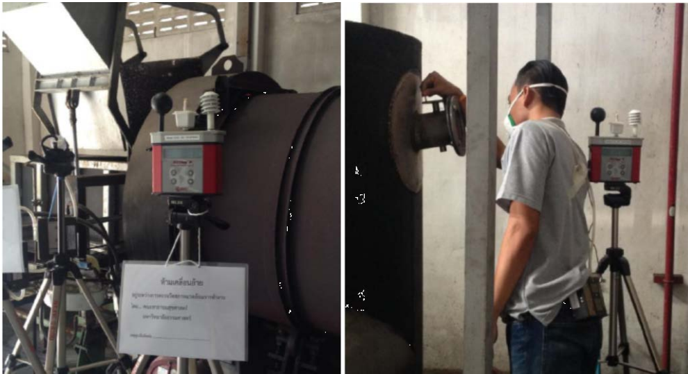
รูปที่ 5-10 การตรวจวัดระดับความร้อนบริเวณจุดป้อนของเสีย และข้างห้องเผาไหม้ที่ 1
