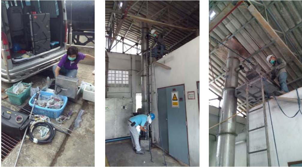
รูปที่ 5-3 เครื่องมืออุปกรณ์การเก็บตัวอย่างคุณภาพอากาศบริเวณปล่องของเตาเผา
