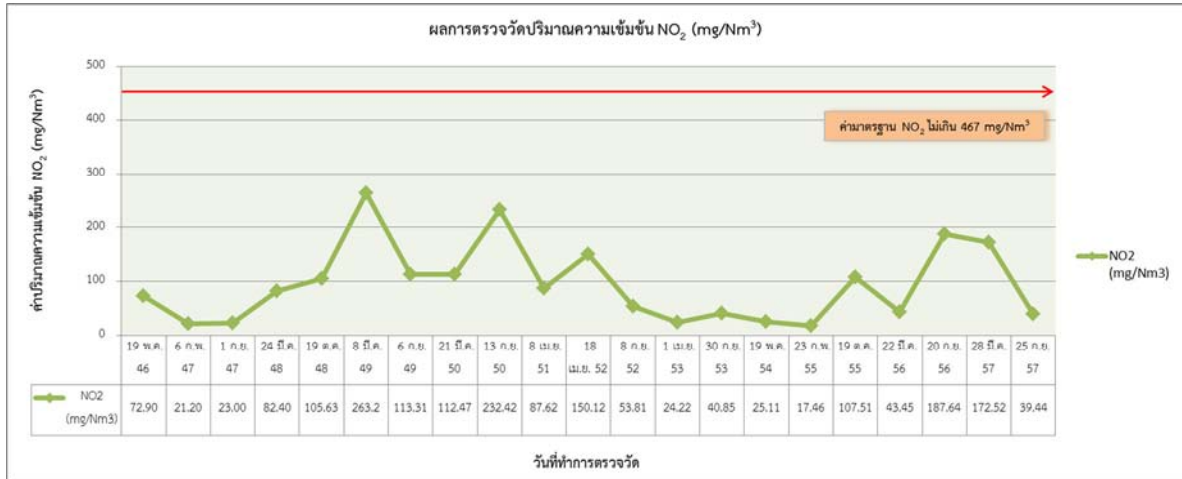
รูปที่ 5-7 ผลการตรวจวัดปริมาณความเข้มข้น NO 2 จากปล่อง (STACK) เตาเผาของเสียอันตราย ตั้งแต่ปีงบประมาณ 2546-2557
