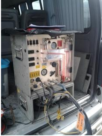
รูปที่ 5-4 เครื่องมืออุปกรณ์การเก็บตัวอย่างคุณภาพอากาศบริเวณปล่องของเตาเผา
