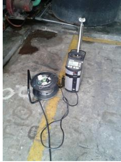
รูปที่ 5-4 เครื่องมืออุปกรณ์การเก็บตัวอย่างคุณภาพอากาศบริเวณปล่องของเตาเผา
